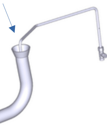
Entleerung über Rohrbogen in Abfluss
